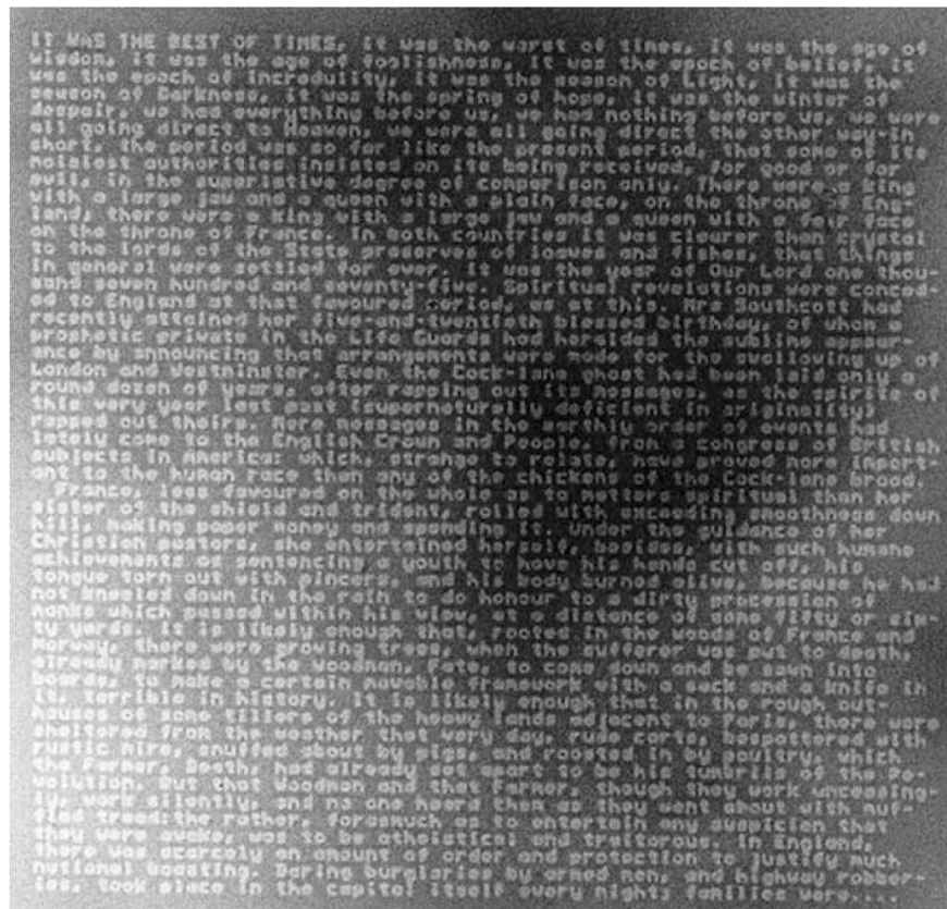
Figura 95 – A página inicial da obra de Charles Dickens, A Tale of Two Cities (Um conto de duas cidades), de 1859, reduzida 25 mil vezes utilizando-se um feixe de elétrons sobre um pedaço quadrado de plástico com lado igual a 0,2 mm.
